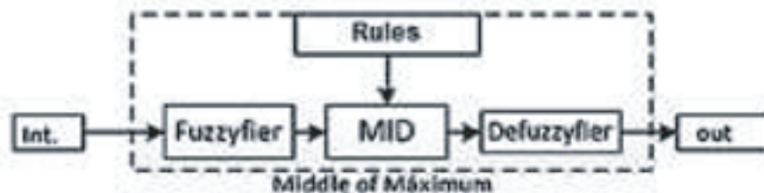
Fig 1. Arquitectura del sistema difuso tipo Mamdani propuesto para la evaluación de los sistemas de clasificación propuestos. Tomada de: (Garay et al., 2019).
